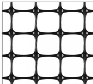
La contribution structurelle de notre géogrille est de renforcer les couches de granulats de routes de zones de circulation ou de chemins de fer, afin de créer une couche mécaniquement stabilisée. Les granulats sont verrouillés avec la géogrille et confinés dans les ouvertures, créant un matériau composite renforcé.
