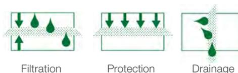
Le géocomposite **NOPPENMATTE** peut être utilisé comme couche de drainage et séparation de matériaux à granulométries différentes et comme protection des étanchéités où l'on ne se trouve pas en présence de sollicitations mécaniques agressives.
