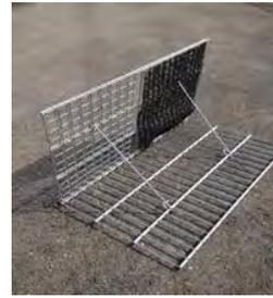
Pour répondre au besoin de durabilité dans le temps des stabilisations de banquettes, tant routiers que ferroviaire, nous avons développé ARSTAB®, un système modulaire innovant, économique et fiable dans le temps. Composé de treillis doubles fils, ARSTAB® est particulièrement rigide et donc résistant aux déformations horizontales. L'utilisation d'un matériau de remblai perméable permet de se dispenser de drainage.
