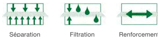
Le géotissé PAVIROCK B est utilisé comme couche de séparation, de filtration et de renforcement entre la sous-couche et l'élément de fondation.
